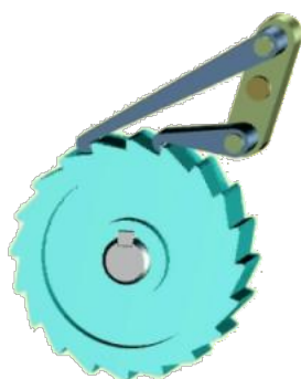
图4 齿式棘轮机构
